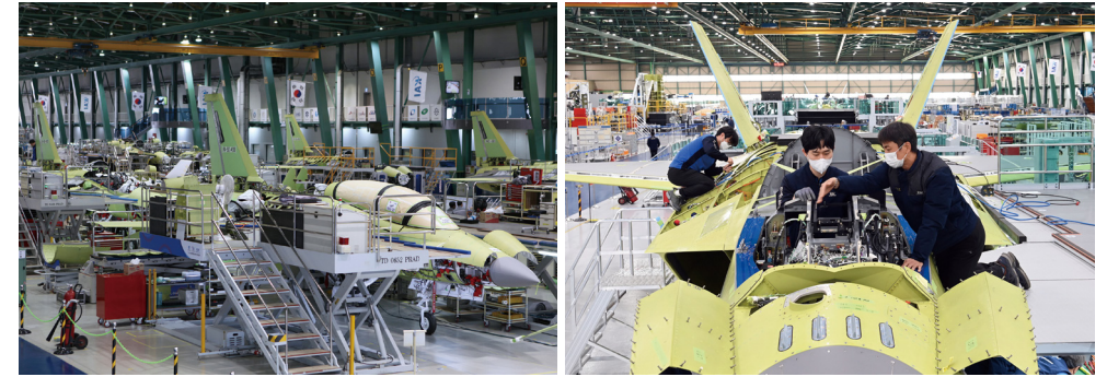
(좌)KAI의 FA-50 생산라인 전경. (우)KF-21(한국형전투기) 조립현장.
